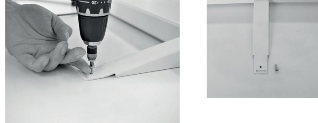
7. Kabelkanal und Kabelkanalhalterungen (2 Stück) herunter schrauben / abclippen.
