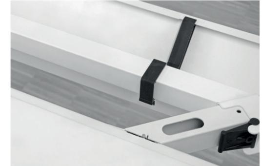
5. Tischgestell um 180° drehen und auf die Tischplatte legen. Der Handschalter muss sich auf der Seite mit den zwei vorgekörnten Bohrlöchern befinden (siehe Abb.).
