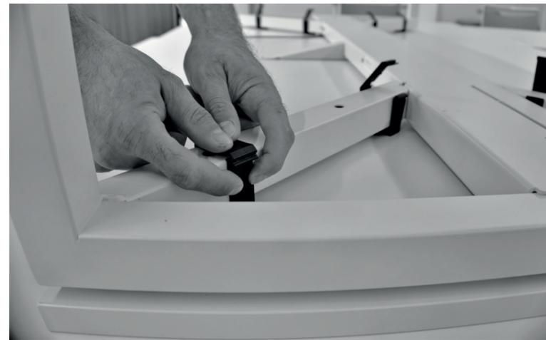
7. Handauslöser mittels Spanplattenschrauben (2 Stück) an die Tischplatte schrauben.
