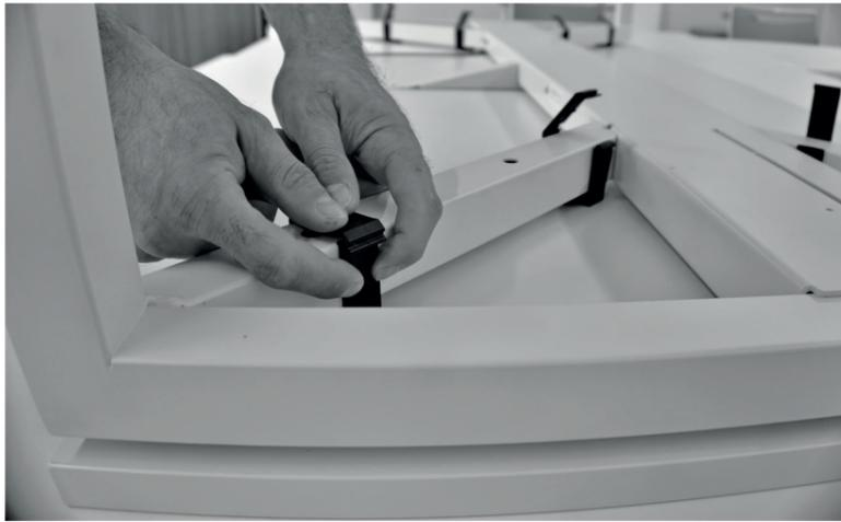
6. Handauslöser mittels Spanplattenschrauben (2 Stück) an die Tischplatte schrauben.
