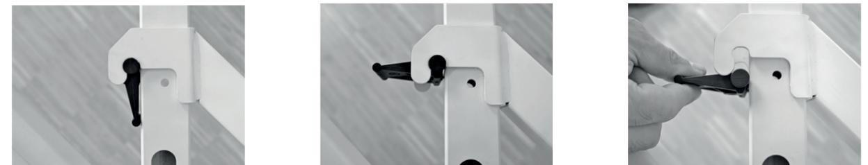
9. Plattenclips öffnen.
