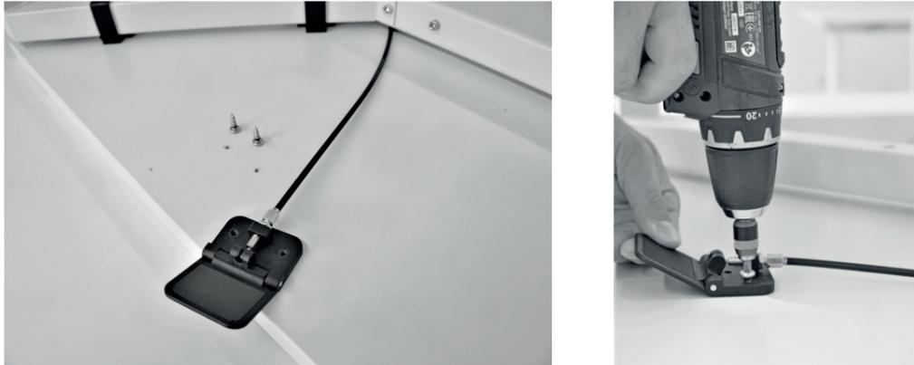
8. Mittelsteg mittels Spanplattenschraube (1 Stück) an die Tischplatte schrauben.
