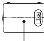
Buchse für Verbindungskabel zur Master-Säule Socket for connecting cable to master column
